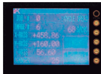
Control PLC con interfaz de pantalla táctil
